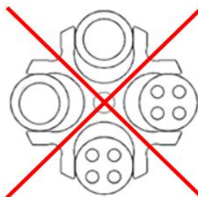
Fig. 5: Godkänd och icke godkänd belastning av en swing-out rotor med olika rörstorlekar (exempel)
