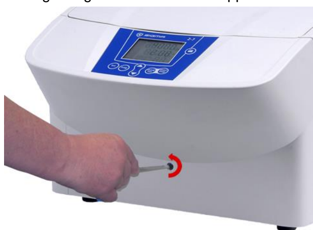
Fig. 11: Manuell upplåsning av locklåset
